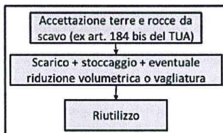
Figura 3.3-5: Diagramma di flusso di trattamento delle terre e rocce da scavo (ex art. 184 bis del D. Lgs.152/2006) e rifiuti inerti
